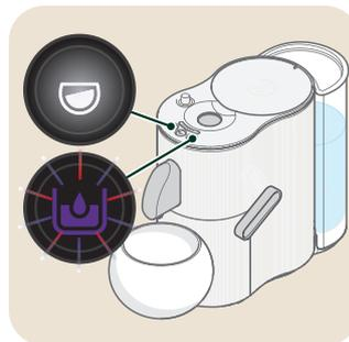
**A)** Coupure du réseau pendant le processus de détartrage (la touche Espresso ☕ s'allume, la touche de nettoyage 🧼 clignote) :
