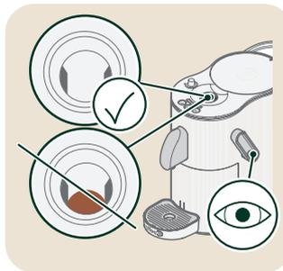
► Vérifier impérativement que le levier de commande est levé et qu'aucune boule ne se trouve dans la chambre d'ébullition.
