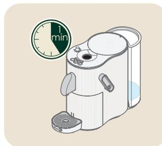
Si la machine à café n'est pas utilisée pendant 1 minute ou si l'on appuie sur la touche de nettoyage ☹ pendant 3 secondes, la machine à café passe en mode d'économie d'énergie.
