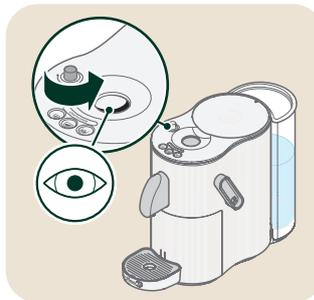
► Fermer le couvercle d'introduction de la boule de café et le maintenir fermé pendant tout le processus de détartrage.
